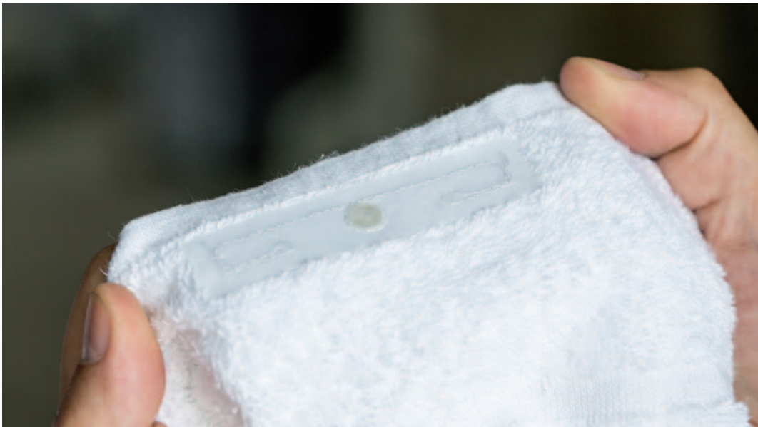
Die speziellen RFID-Chips überstehen die vielen Waschgänge besser als die Wäschestücke. Künftig sollen sie so klein werden, dass sie in den Nähten der Handtücher und Bettlaken verschwinden.
